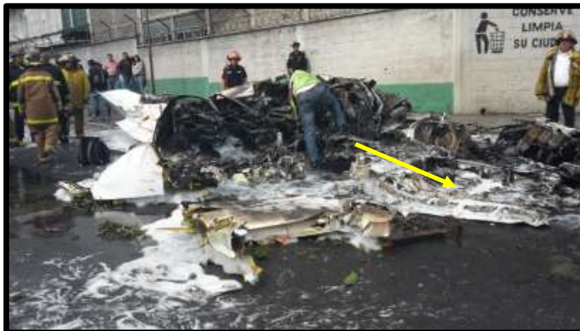
Fotografía No.: 02 Vista lateral derecha del fuselaje, ala derecha incinerada.
