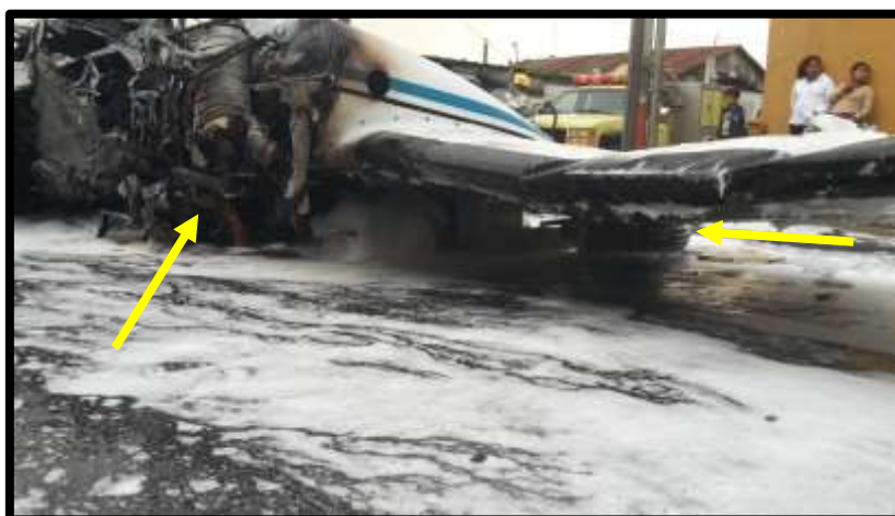
Fotografía No.: 06 Vista de los restos del motor y tren principal de aterrizaje lado izquierdo.
