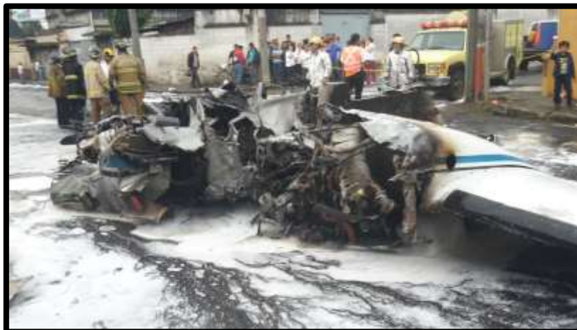
Fotografía No.: 15 Vista del daño por fuego al fuselaje lado izquierdo.
