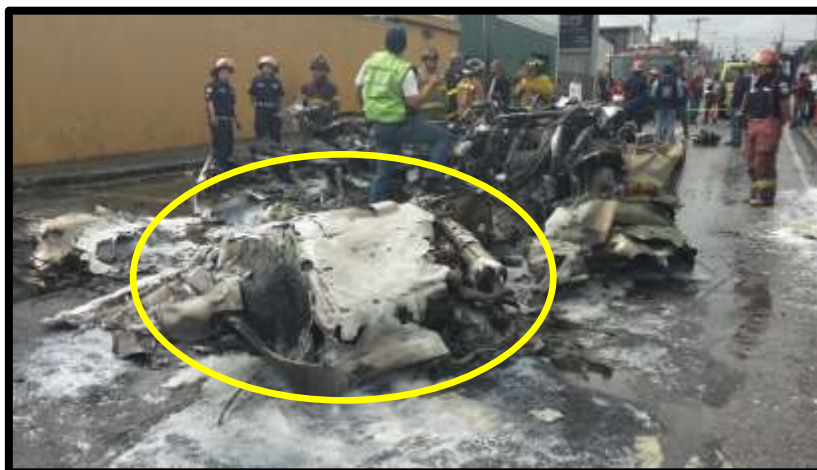
Fotografía No.: 03 Vista de los restos del motor derecho y la hélice.
