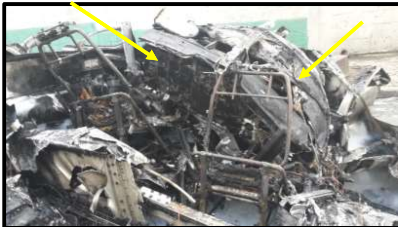
Fotografía No.: 10 Vista del panel de instrumentos y sillas de piloto y copiloto.
