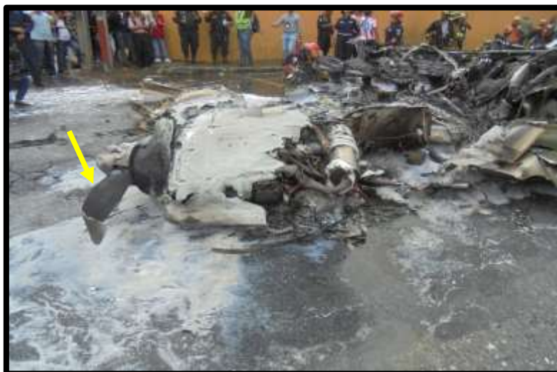
Fotografía No.: 13 Restos de la hélice del motor derecho.
