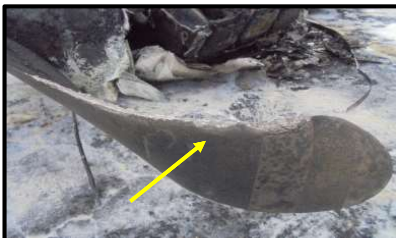
Fotografía No.: 14. Vista del daño causado a la hélice por impacto.
