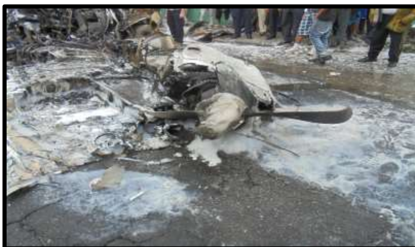
Fotografía No.: 16. Vista del daño a la hélice por impacto.
